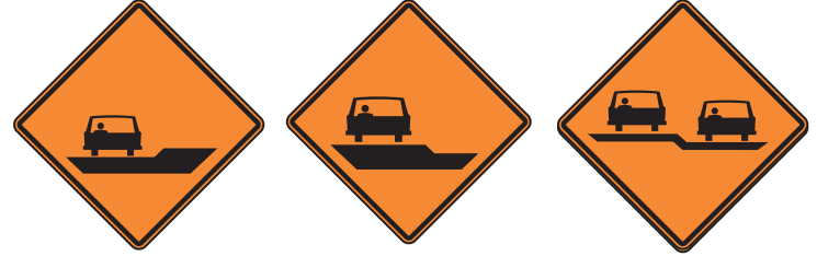
أمامك جانب طريق مرتفع. اختلاف في مستوى الأرض بسبب أعمال الإنشاء
